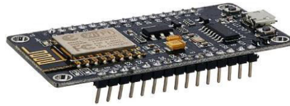
Figure.8.WI-FI NODE MCU MODULE
